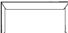
> Umschläge mit beidseitigen vertikalen Nähten an den Umschlagenden. Obwohl auch dieser Umschlagtyp gut eingezogen wird, sind sie doch anfälliger für Staus als Umschläge mit diagonalen Nähten.
