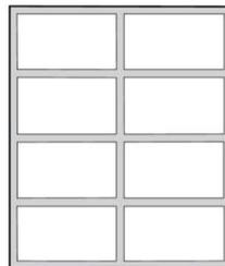
Zwischen den einzelnen Etiketten erscheinen Zwischenräume mit Kleber. Die Klebeschicht muss unbedingt vollständig von den Aufklebern bedeckt sein, so dass zwischen den einzelnen Etiketten keine Zwischenräume erscheinen. Andernfalls können sich die Aufkleber während des Druckens lösen und zu Papierstaus führen.
