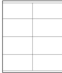
Ist das Etikett bis zum Rand bedeckt, kann Kleber an den Stoßkanten austreten. Eine Schutzkante ohne Kleber verhindert dies wirkungsvoll.
