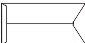
Umschläge mit einer Mittelnahrt und Endklappen. Dieser Umschlagtyp wird verlässlich eingezogen, vorausgesetzt, die Umschläge werden so eingelegt, dass die Seite mit den gefalteten Endklappen zuerst in den Drucker, Kopier- bzw. Multifunktionssystem eingezogen wird.
